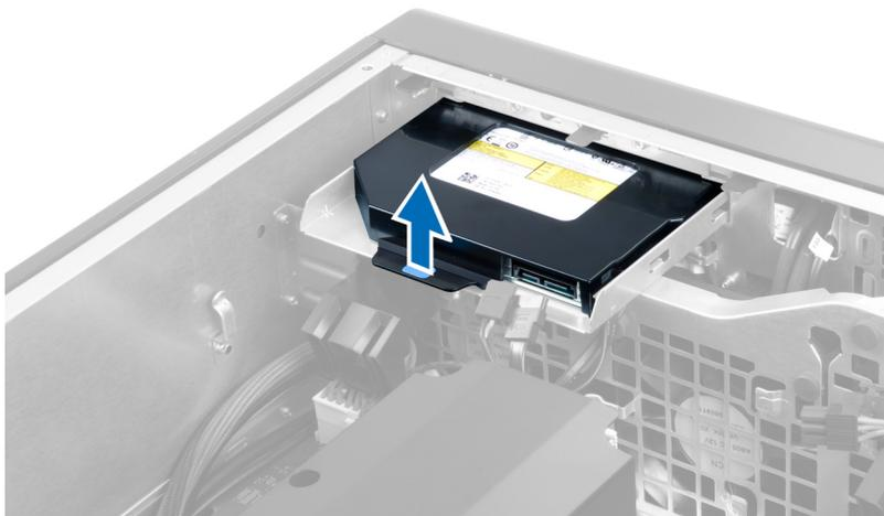
6. Schieben Sie das optische Laufwerk aus seinem Fach und heben Sie es nach oben, um es aus dem Computer zu entfernen.
