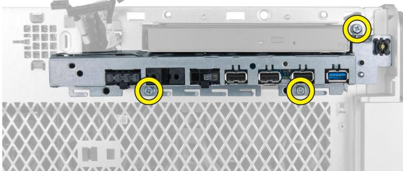
5. Ziehen Sie die E/A-Leiste in die dem Computer entgegengesetzte Richtung, um ihre Ecke aus der Gehäuseklammer zu lösen.
