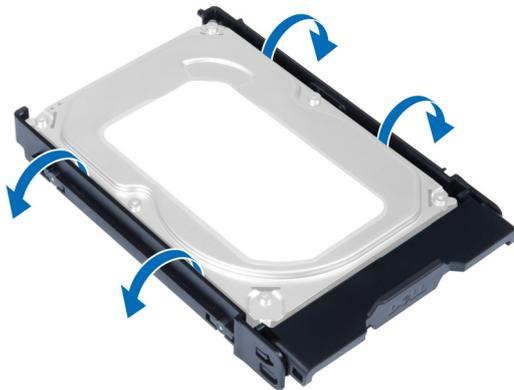
8. Heben Sie das Festplattenlaufwerk nach oben, um es aus der Festplattenlaufwerkhalterung zu entfernen.
