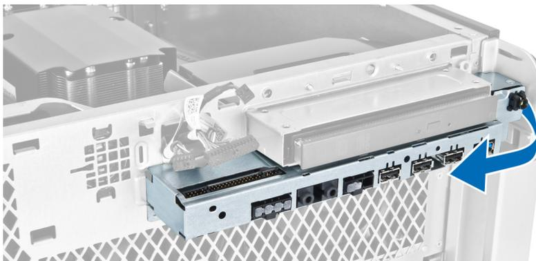
6. Schieben Sie die gegenüberliegende Seite der E/A-Leiste nach außen, um das E/A-Modul aus dem Gehäuse zu lösen.
