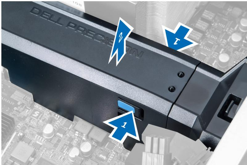
4. Drücken Sie auf den Entriegelungsriegel auf der anderen Seite des Lufttunnelmoduls, um es aus dem Gehäuse zu lösen.
