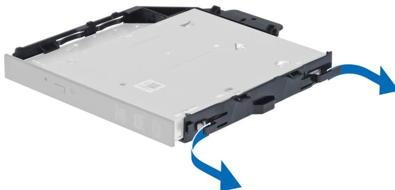
8. Heben Sie das optische Laufwerk nach oben und entfernen Sie es aus der Halterung.
