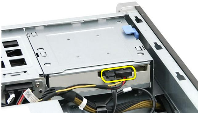
4. Drücken Sie auf den Entriegelungsriegel (1) und schieben Sie das optische Laufwerk heraus, um es aus dem Laufwerkschacht (2) zu lösen
